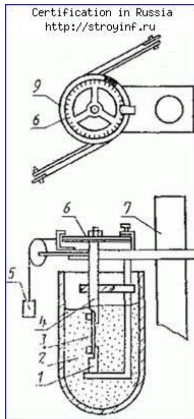
1, 4-зажимы; 2-охлаждающая смесь; 3-образец; 5-груз; 6-шкала в градусах; 7-опорная стойка; 8-сосуд Дьюара; 9-стрелка.
